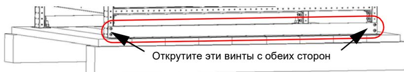
Рис. 2 - Снятие L-образного профиля
